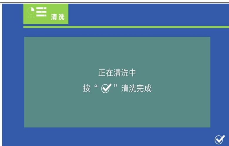
主菜单选择“清洗管道”功能。仪器内部的清洗泵开始工作，约等待1~2分钟后，可以按右下角的“✓”按键。则清洗完成。
