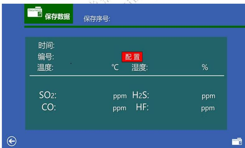
按红色“配置”按钮可以输入测试编号，确认无误后可以按右下角的“保存数据”，将当前数据保存到仪器内部。仪器最多可以保存 1000 条数据。
