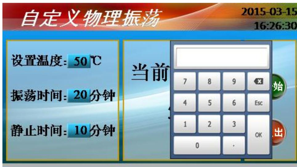
按“设定温度”、“振荡时间”、“静止时间”项目数字显示区，用小键盘改变数值，输入合适的数值后按“OK”键，如下图所示：
