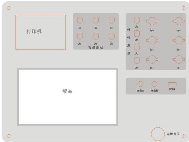
图一 操作面板布置示意图
