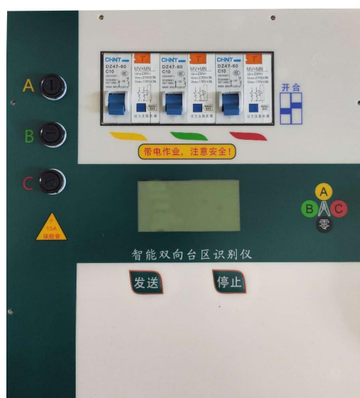
图3 智能双向台区识别仪发送器面板示意图
