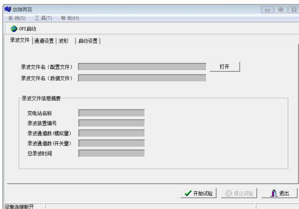
本程序是将 Comtrade 格式的录波文件读出,在界面上显示变电站名称、模拟量通道数、开关量通道数、各段数据的采样频率及采样点数和总采样点数等信息。用户再自行定义测试仪的电压通道、电流通道的对应于录波文件中的相应通道,然后可计算波形并显示在屏幕上,点击【输出】按钮即按显示的波形输出。
